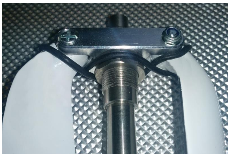
Die Montage des Propgummis erfolgt über Kreuz wie hier dargestellt. Der Gummi muss in der Nut der Mutter liegen .
