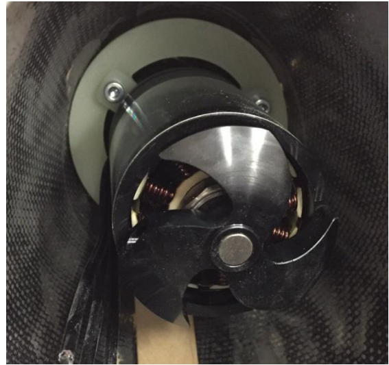
Ringspalt auf Passung prüfen und punktuell verkleben
