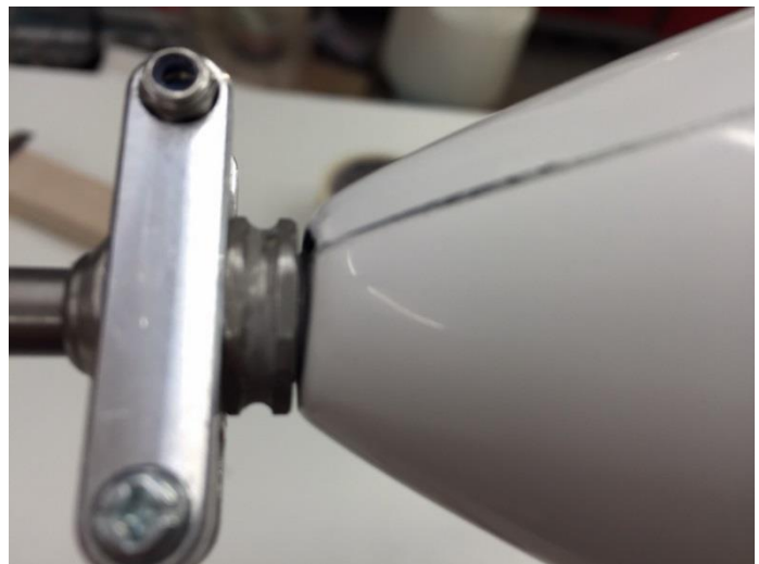
Eingesteckter Kugellastbozen – Mutter darf nicht am Rumpf streifen !
